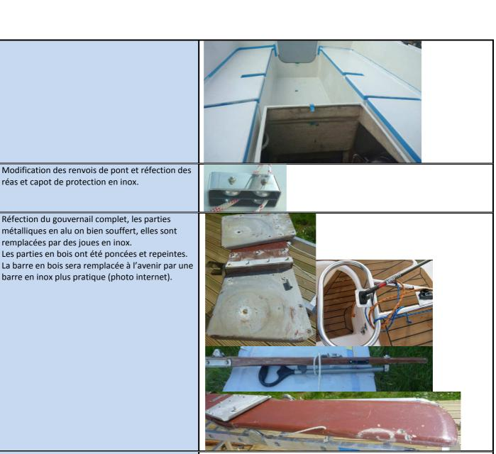
Démontage et remontage complet de l'accastillage (sauf le rail d'écoute du génois) échange des poulies, vérification et lubrification des pièces en mouvement...
